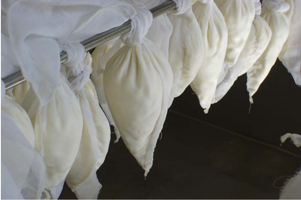
Ek Şekil 1.2. Doğal süzülme sırasında şekil verilerek parzınların ağzının sıkılması
