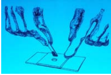
Şekil 17: Kalıp kullanarak belirli ölçüde numuneyi lama alma(33).
