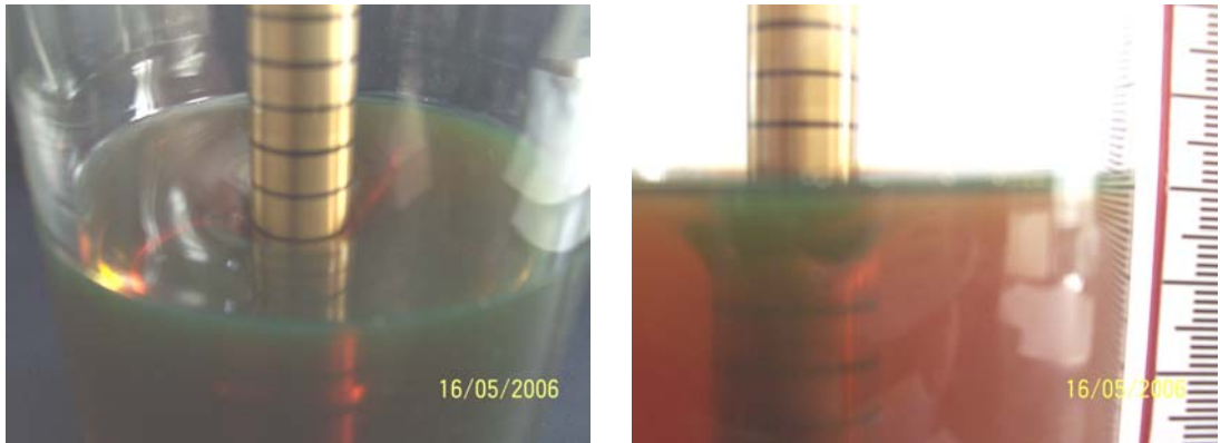
Şekil 4.155. Motor yağının dönen mildeki hareketi
