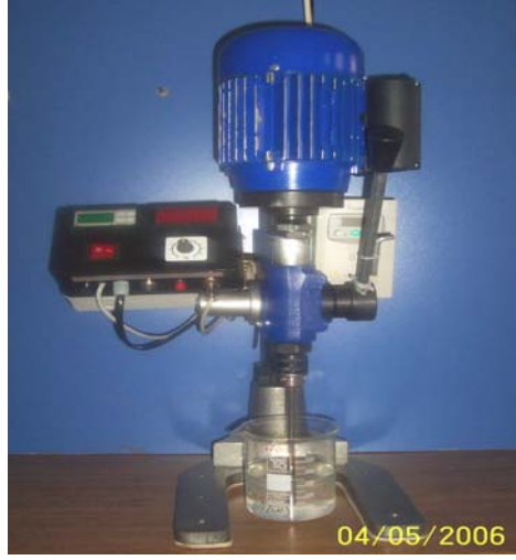
Şekil 3.5. Mil tırmanma (Rod-Climbing) aparatı
