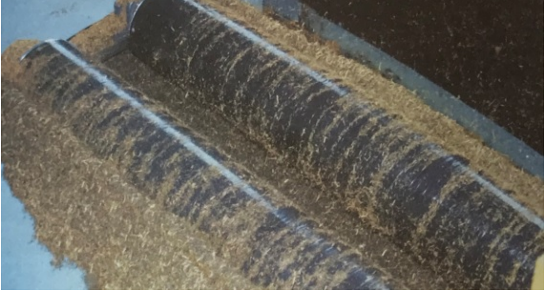
Şekil 2.9. Sap, lif ve tozların ayrılması için elektrostatik ayırıcı. (Kacar, 2010, s. 226)
