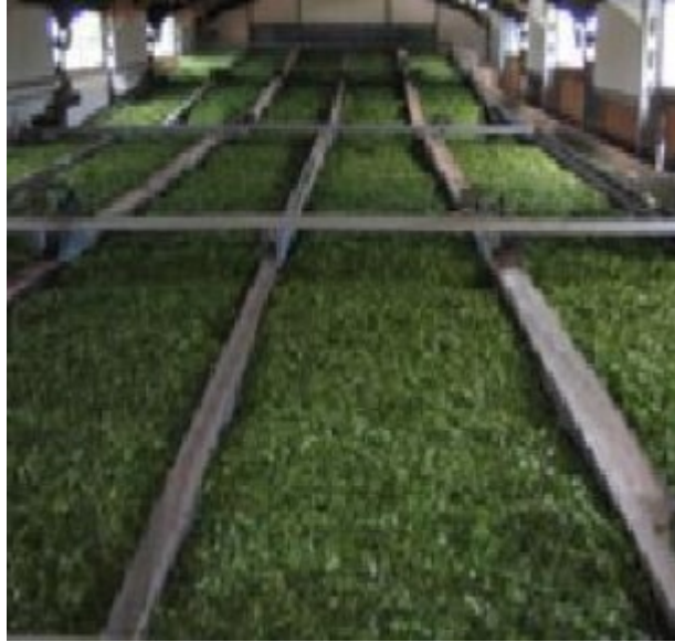
Şekil 2.4. Soldurma Makinası (MEB, 2011, s. 7)
