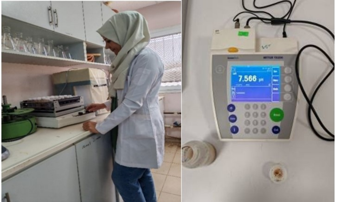
Şekil 3.5. Çalkalama işlemi ve pH metre
