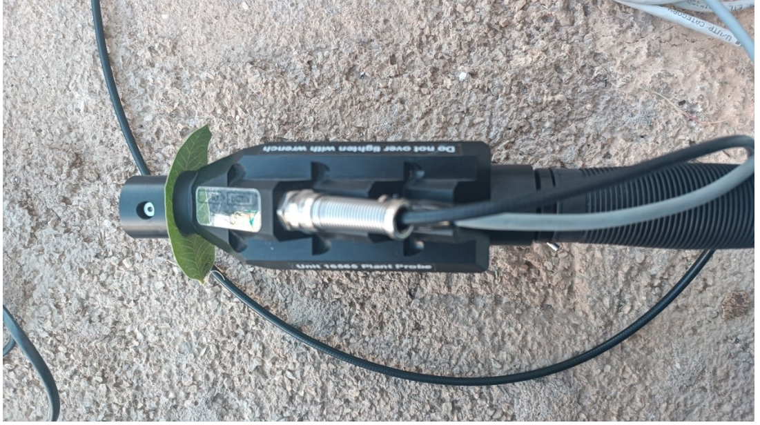
Şekil 3.15. Antep fıstığı yapraklarının spektrometre kontakt probe ile yansımaların elde edilmesi
