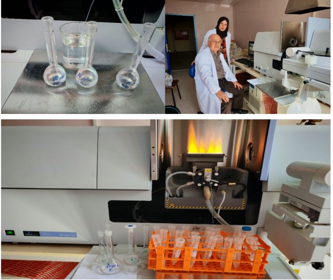
Şekil 3.19. Atomik Absorpsiyon Spektrofotometre ile Na ve K okuması
