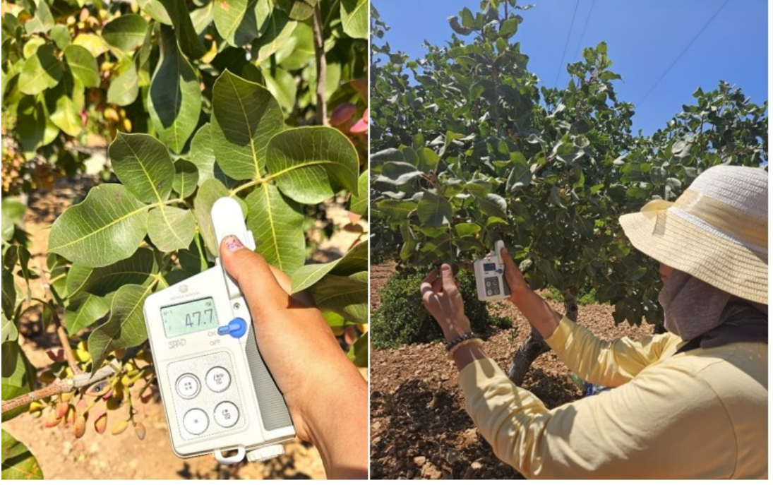
Şekil 3.13. Antep fıstığı yapraklarında Spad ölçümü (Minolta SPAD-502)
