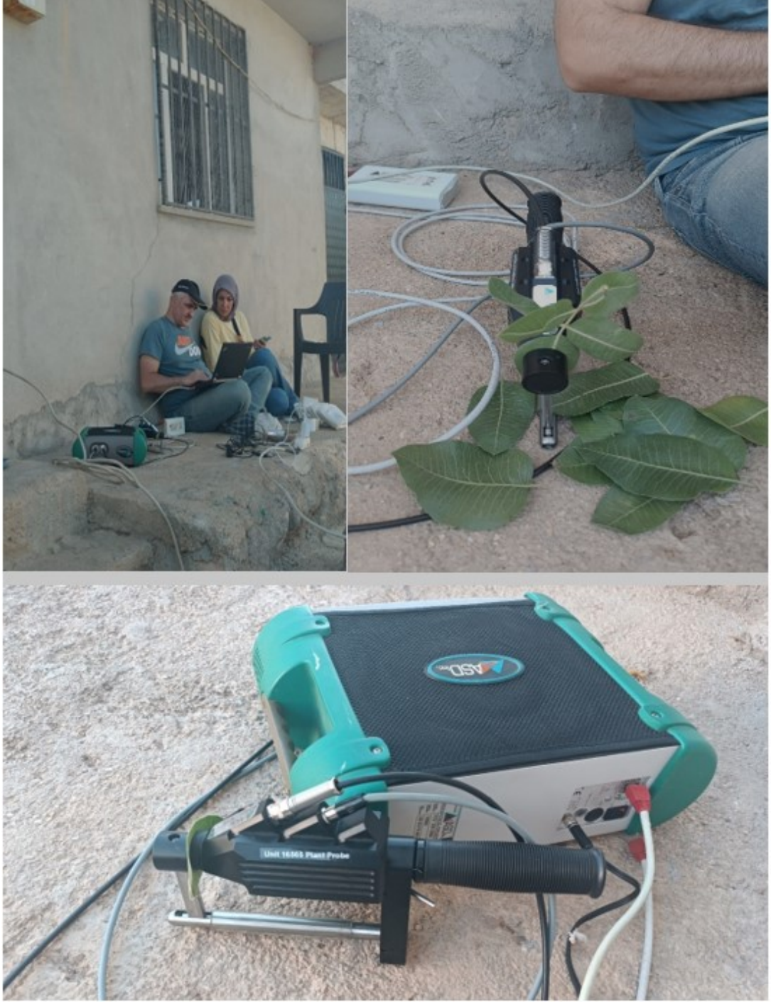
Şekil 3.14. Antep fıstığı yapraklarının spektrometre yansımalarının elde edilmesi
