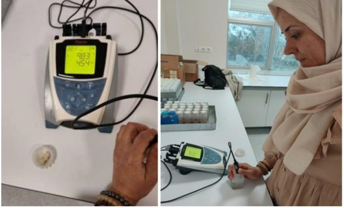
Şekil 3.6. EC metre ve EC okumasını yaparken ki görüntü
