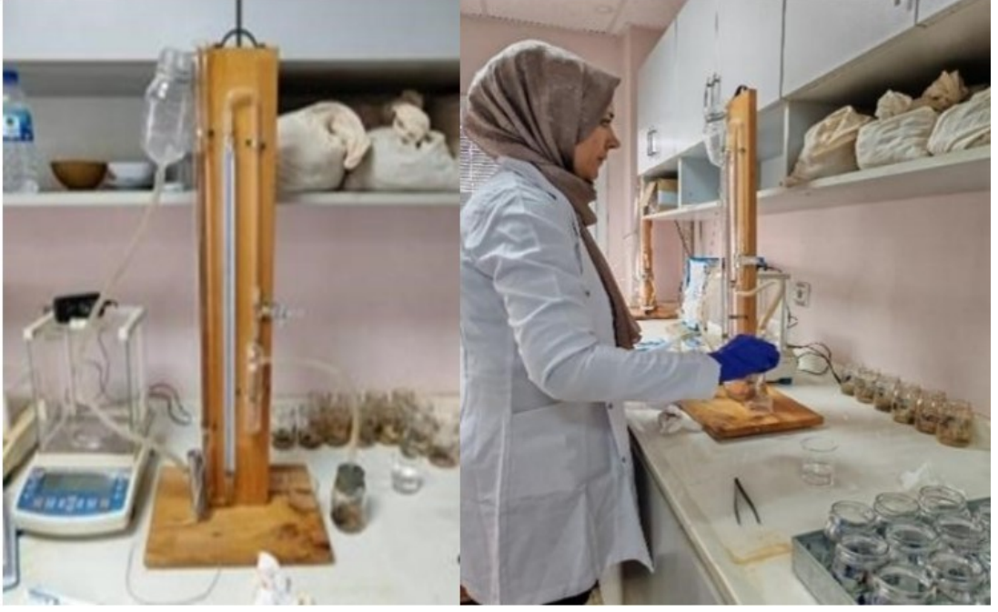
Şekil 3.4. Scheibler kalsimetre ve kalsimetre ile ölçüm
