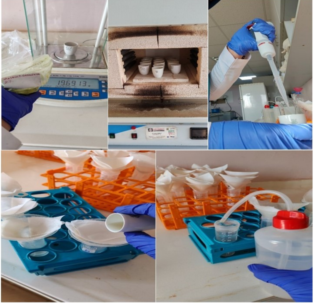
Şekil 3.18. Öğütülen yaprak numunelerinin fırınlanması ve HCl çözeltisi eklenerek süzüntü haline getirme işlemi
