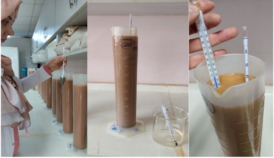
Şekil 3.10. Hidrometre okuması ile sıcaklık ölçümü
