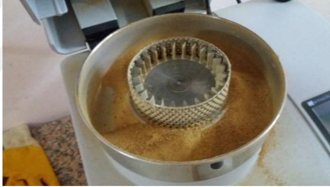
Şekil 3.3. Nar kabuğunun santrifüj çekiçli değirmende öğütülmesi ( Retsch ZM200 )
