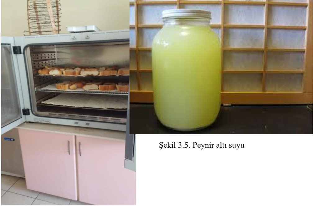
Şekil 3.4. Ekmeğin etüvde kurutulması (105°C’de 2 saat)
