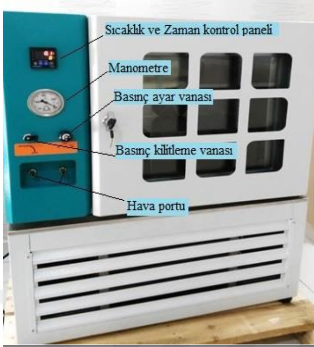
Şekil 3.3. İmalatı tamamlanmış dondurarak kurutucu sistemi
