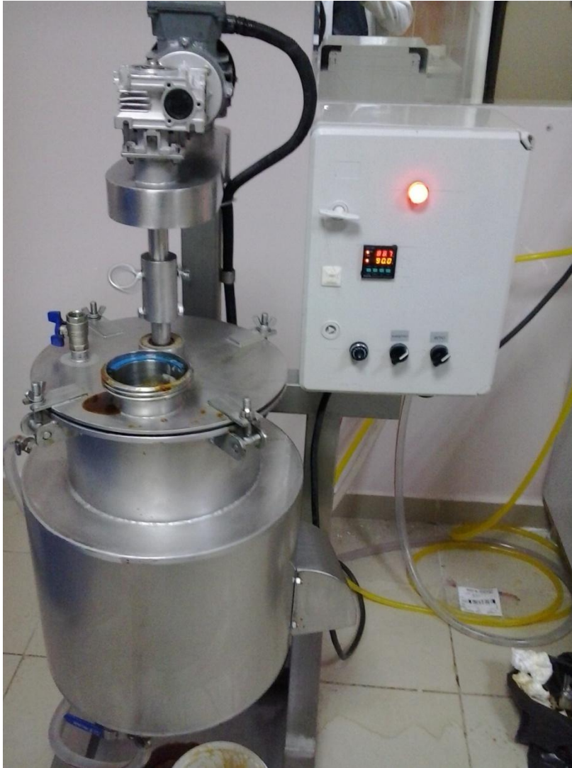
Şekil 3.1. Runi hizin muhtemel endüstriyel üretimi için özel tasarlanmış pastörizatör cihazı
