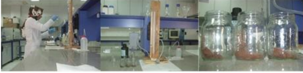
Şekil 4.4. Saksılardan alınan toprak örneklerinde katalaz enzim aktivitesi analizinin yapılması
