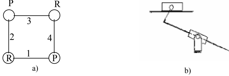
Şekil 3.14. PRPR zincirinin kinematik yer değişimi ile türetilen mekanizmalar
