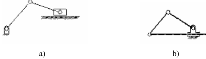
Şekil 3.5. a) Krank-biyel mekanizması (1.tip), b) Krank-biyel mekanizması (2.tip)
