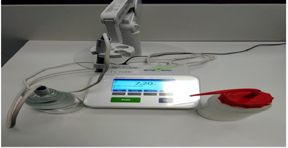
Şekil 3.4. Çalışmalarda kullanılan iletkenlik ve pH ölçüm cihazı.
