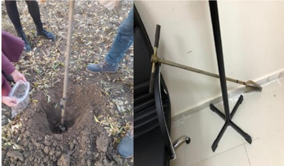
Şekil 3.6. Toprak örneği alımında kullanılan burgu
