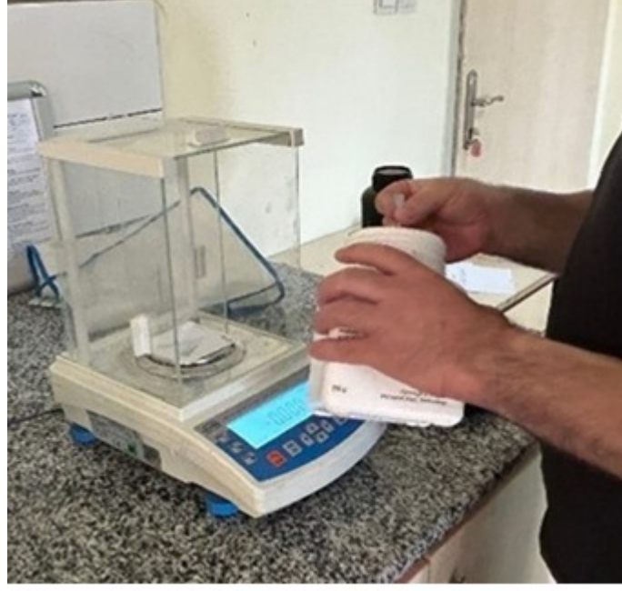
Şekil 3.1. Titanyum dioksit ( \text{TiO}_2 ) nanopartiküllerinin belirlenen oranlara göre hassas terazi kullanılarak tartılması.
