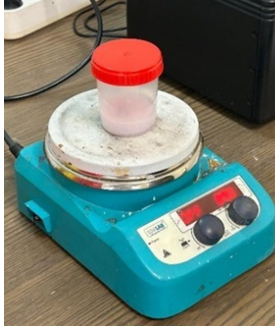
Şekil 3.3. Reçine ile TiO 2 nanopartiküllerinin manyetik karıştırıcıda karıştırılması.
