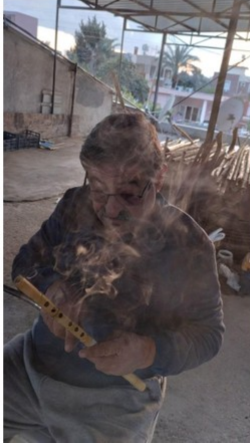
Şekil 2.28. Ney Perdelerinin Açılması (Demireğen, ney perdelerini sürtünme yoluyla yakarak açmaktadır.)
