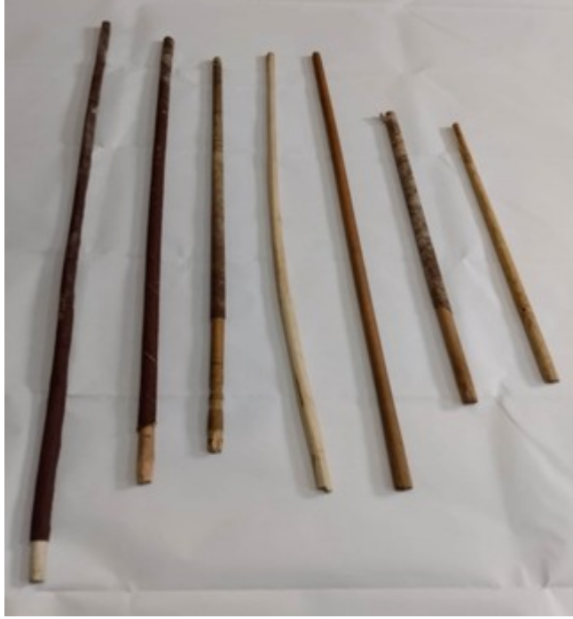
Şekil 2.19. Ney yapımcıları demir eyeleri kullanırken Salih Demireğen zakkum ağacından yaptığı aparatları kullanmaktadır. Böylelikle boğumlar eşit ve kontrollü bir biçimde açılmakta, akort probleminin önüne geçilmektedir. Ayrıca zakkum ağacının antibakteriyel özelliği ney sazında küflenme probleminin önüne geçmektedir.
