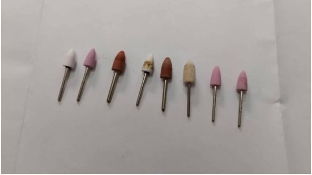
Şekil 2.21. Ney yapımıcıları özel yapım matkap uçlarını kullanırken Salih Demireğen taş uçlu zımparaları kullanmaktadır. Metal uçlar kamışı direkt delerken taş uçlar ise sürtünme yoluyla yakarak perdeleri açmaktadır. Bu daha kontrollü açkı ile seslerin daha sağlıklı çıkmasını sağlamaktadır.
