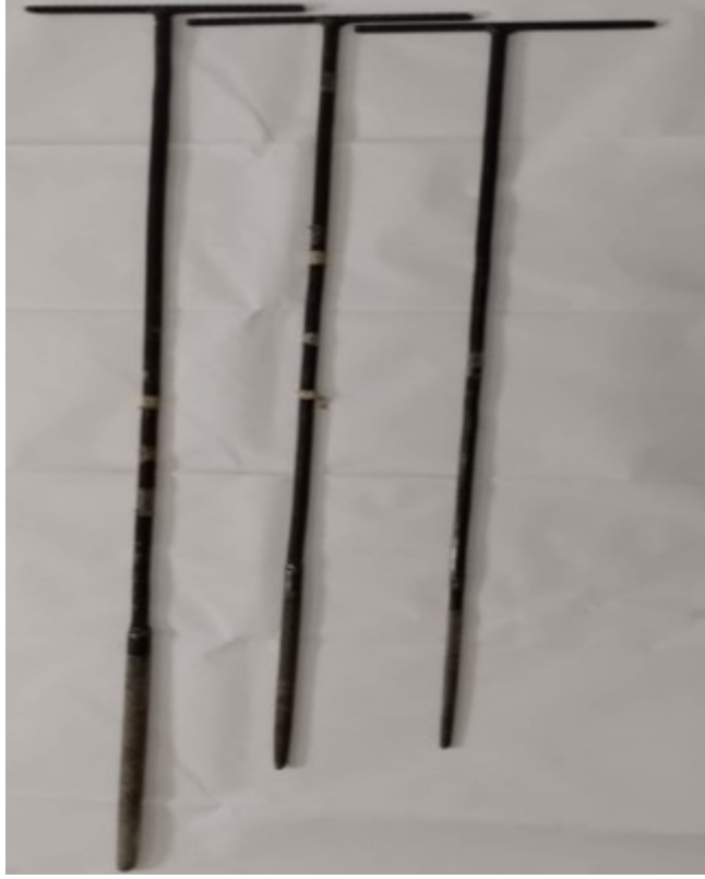
Şekil 2.18. Ney Açmada Kullanılan Törpüler
