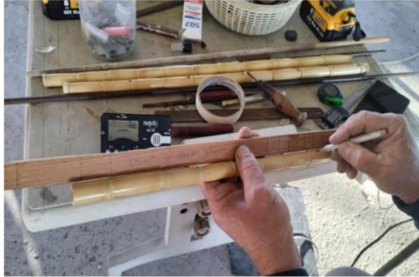
Şekil 2.27. Kurutulan Kamışın Ney Açmaya Hazır Hale Gelmesi
