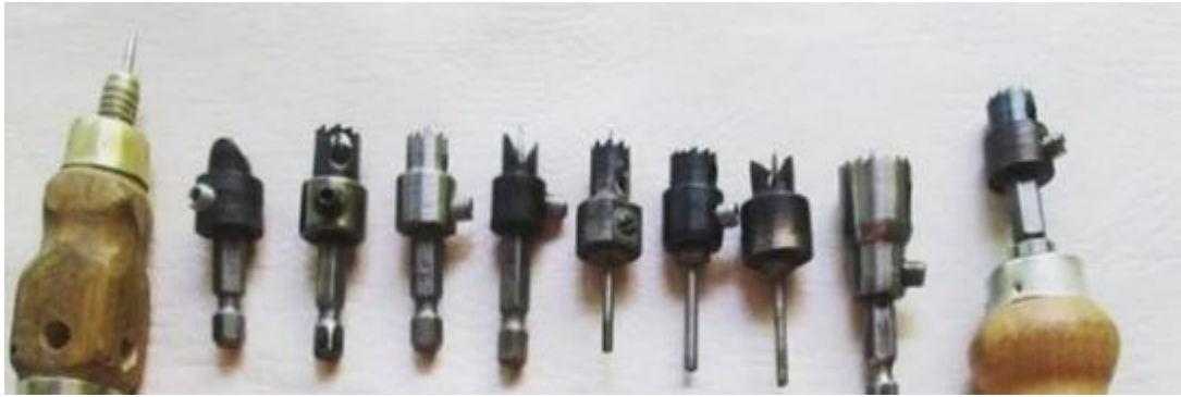
Şekil 2.19. Ney yapımcıları demir eyeleri kullanırken Salih Demireğen zakkum ağacından yaptığı aparatları kullanmaktadır. Böylelikle boğumlar eşit ve kontrollü bir biçimde açılmakta, akort probleminin önüne geçilmektedir. Ayrıca zakkum ağacının antibakteriyel özelliği ney sazında küflenme probleminin önüne geçmektedir.
