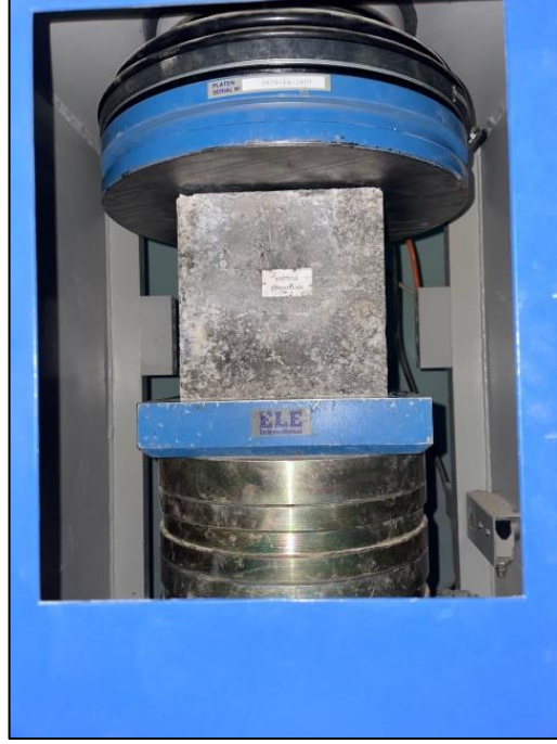
Şekil 3. 10. Basınç dayanımı deneyi
