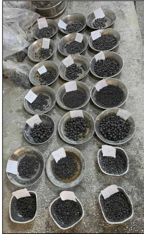
Şekil 3. 5. Farklı fraksiyonlarda ve farklı kaplama kalınlıklarına sahip GKA agregaları
