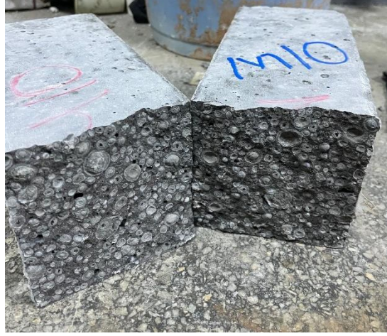
Şekil 4. 4. Eğime dayanımı deneyi sonrası beton numunesinin görünümü
