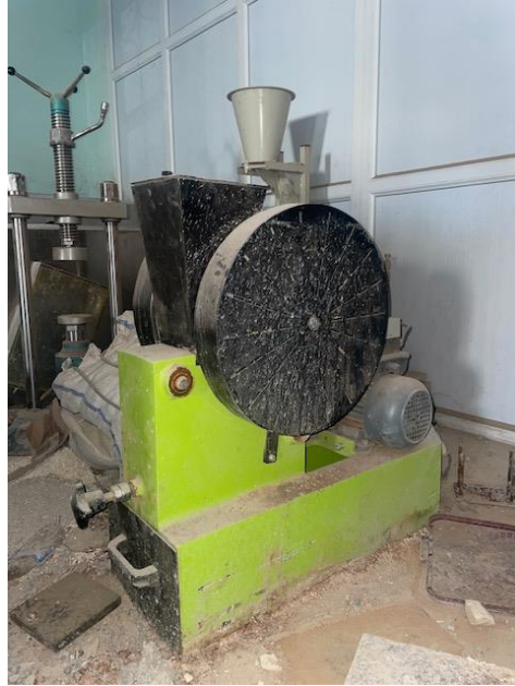
Şekil 3.2. GKA agregasının boyutlandırılmasında kullanılan laboratuvar tipi kırıcı
