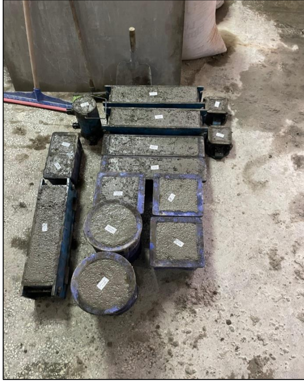
Şekil 3. 8. Taze beton numunelerinin kalıplanması işlemi
