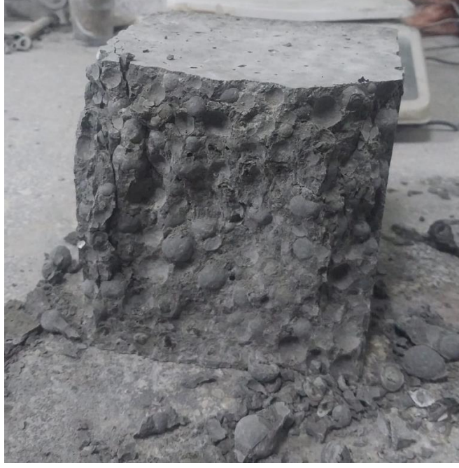
Şekil 4. 2. Basınç deneyi sonrası beton numunesinin görünümü
