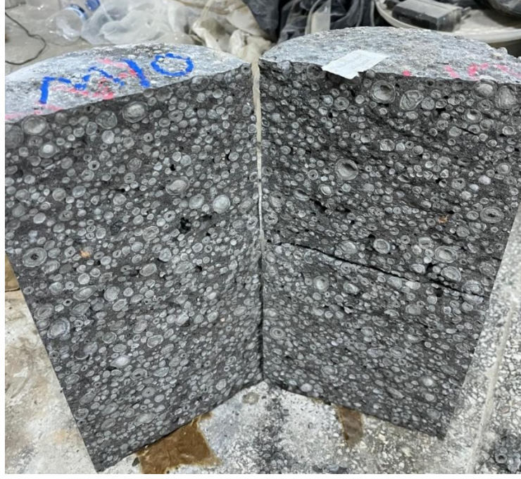
Şekil 4. 6. Yarmada çekme deneyi sonrası beton numunesinin görünümü
