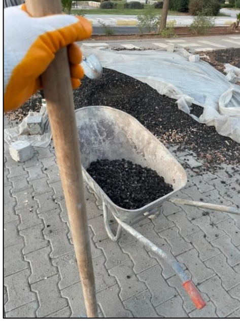
Şekil 3.1. Deneysel çalışmalarda kullanılan GKA agregaları
