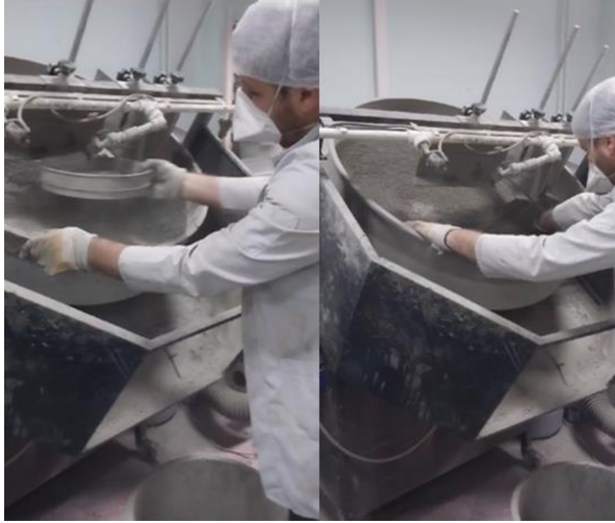
Şekil 3. 4. Yüzeyi kaplanan GKA agregalarının üretim süreci
