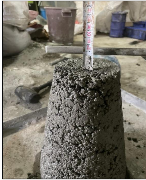
Şekil 3. 7. Taze beton karışımı üzerinde yapılan çökme deneyi
