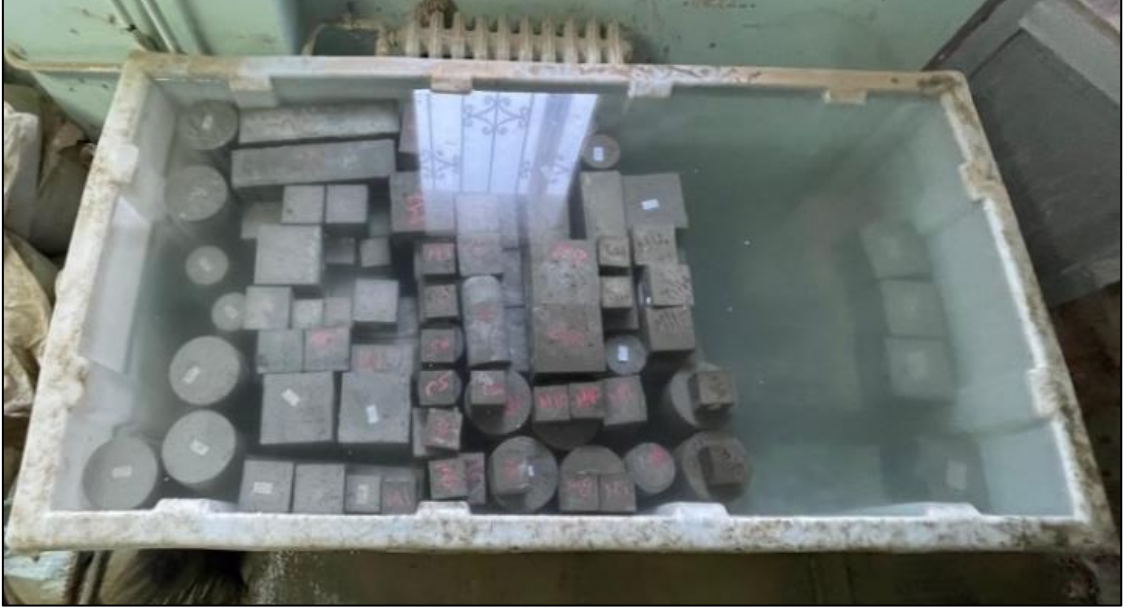
Şekil 3. 9. Beton numunelerin kür havuzunda bekletilmesi
