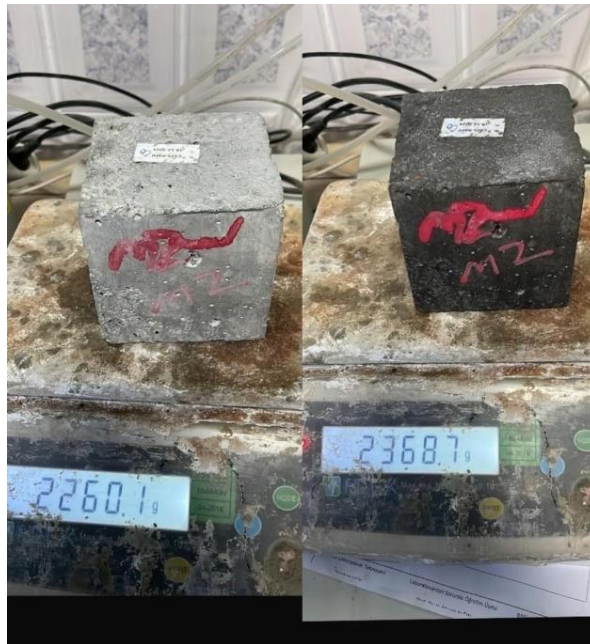
Şekil 3. 13. Su emme deneyi
