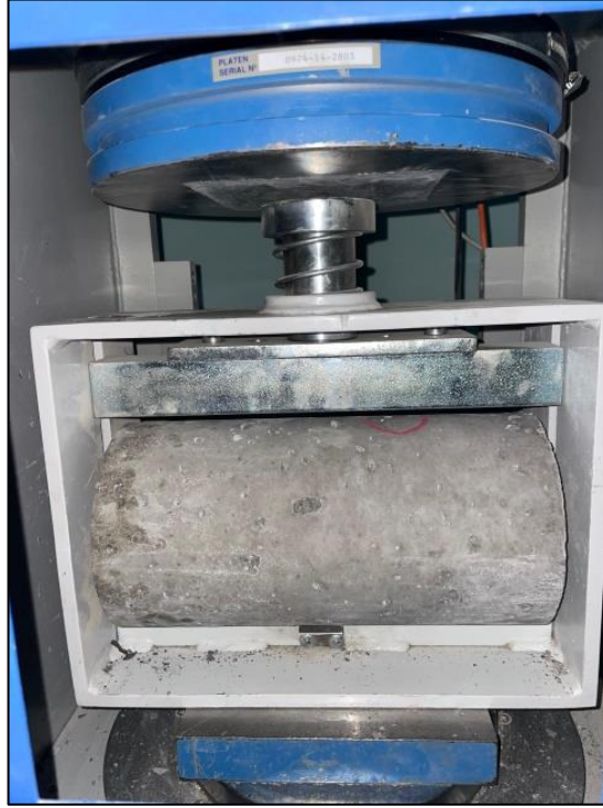
Şekil 3. 12. Yarmada çekme dayanımı deneyi
