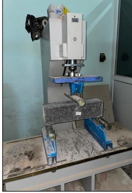
Şekil 3. 11. Eğilme dayanımı deneyi
