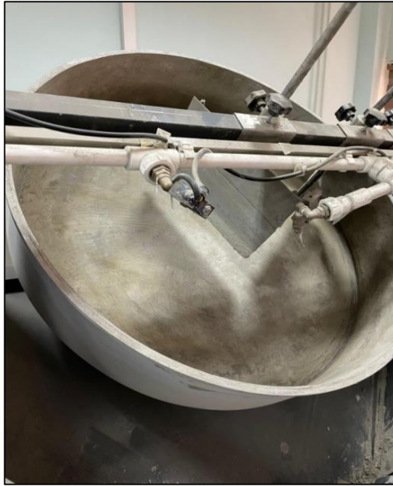
Şekil 3. 3. GKA agregalarının kaplanmasında kullanılan peletleme cihazı
