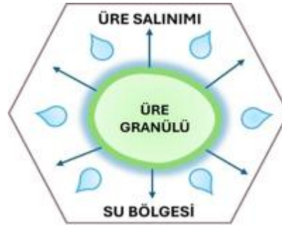
Şekil 2.1. Kaplamalı üre granülünün yavaş salınımı ( Öztürk vd.,2024)
