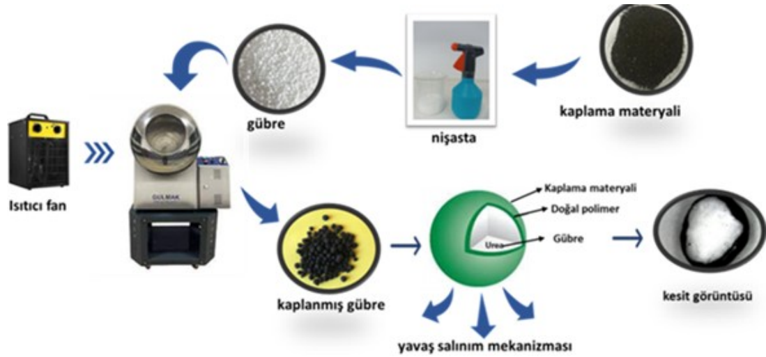
Şekil 3.2. Üre ve DAP gübre kaplamalarının üretim sürecinin şeması
