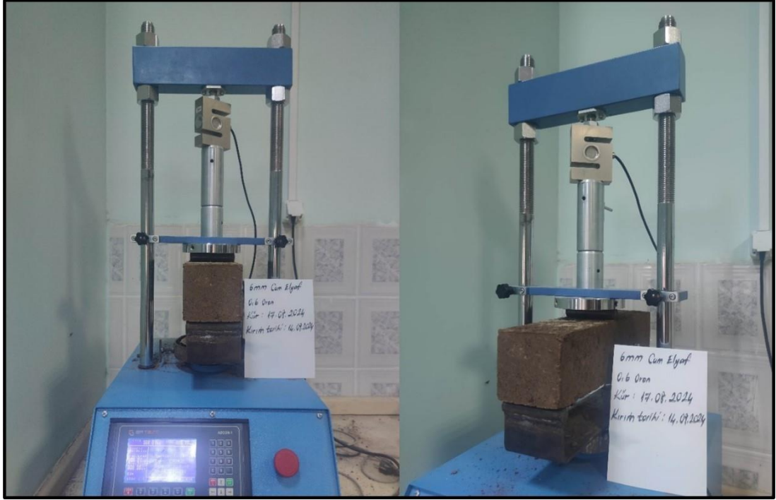
Şekil 3.16. Cam elyaf katkılı numunelerin eğilme deneyleri
