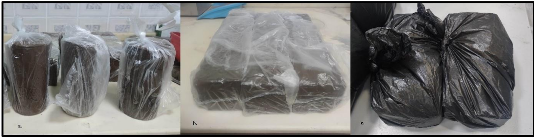
Şekil 3.8. Silindirik ve priz biçimindeki numunelerin kılma işlemleri
