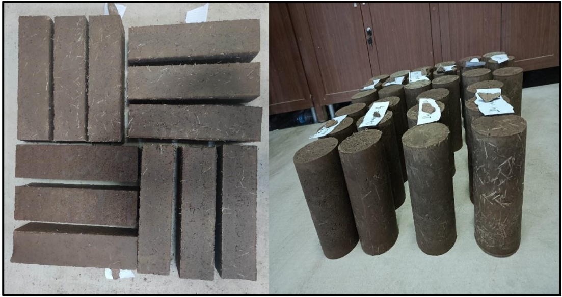
Şekil 3.14. Kürlemeye alınmak üzere kalıplardan çıkarılan silindir ve kiriş biçimindeki cam elyaf katkılı numuneler
