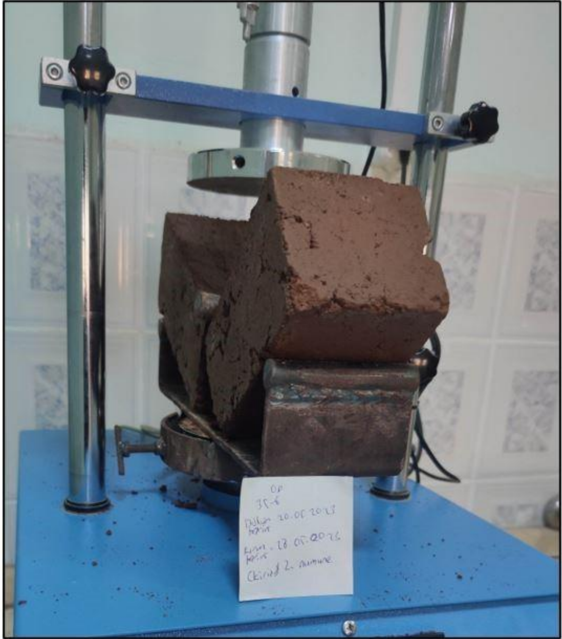
Şekil 3.9. Kiriş kontrol numunelerinin eğilme deneyleri
