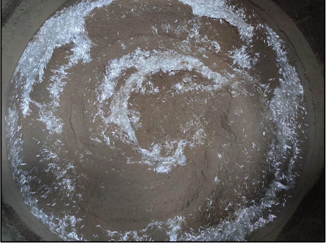
Şekil 3.12. Killi zemin, cam elyaf ve uçucu kül karışımı görünümü
