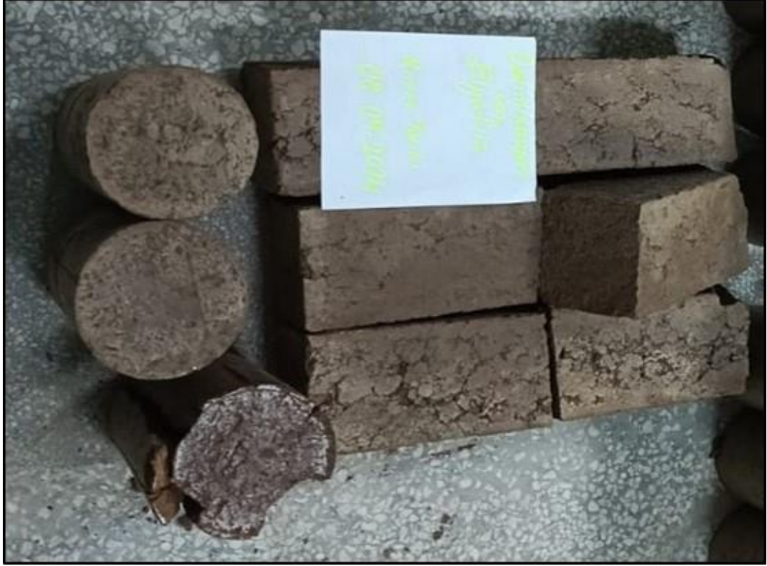
Şekil 3.11. Silindir ve kiriş kontrol numunelerinin serbest basınç ve eğilme deneyleri sonrasındaki görünümü
