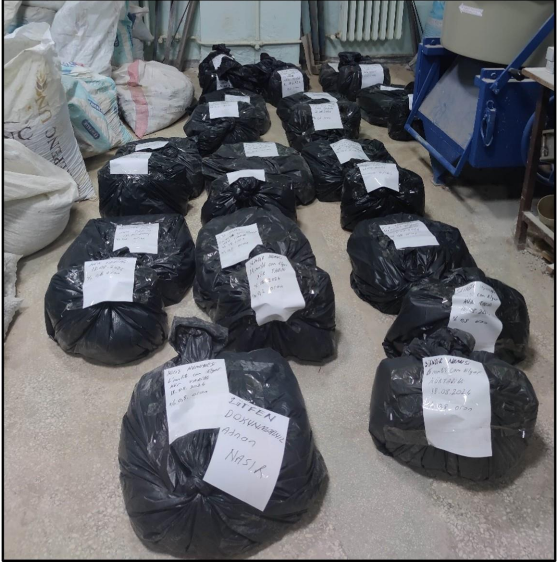
Şekil 3.15. Kürlemeye alınan silindir ve kırış biçimindeki cam elyaf katkılı numuneler
