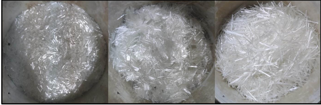
Şekil 3.2. Cam elyaf boyları; a) 6 mm, b) 12 mm, c) 24 mm
