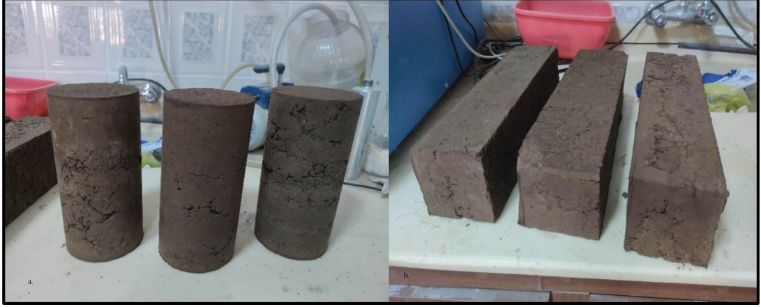
Şekil 3.7. Kırılma öncesi kalıplardan çıkarılan silindirik ve priz kontrol numuneleri
