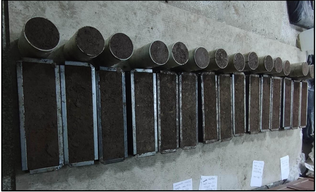
Şekil 3.13. Silindir ve kiriş formundaki cam elyaf katkılı numuneler
