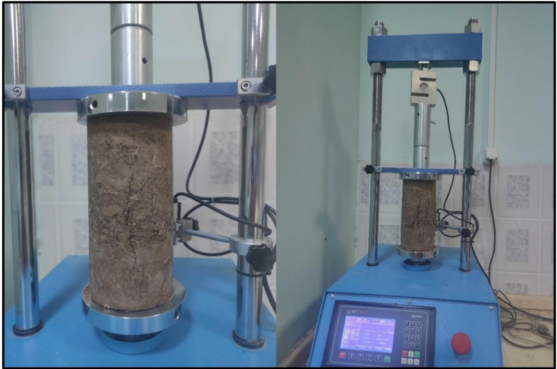
Şekil 3.17. Cam elyaf katkılı numunelerin serbest basınç deneyleri
