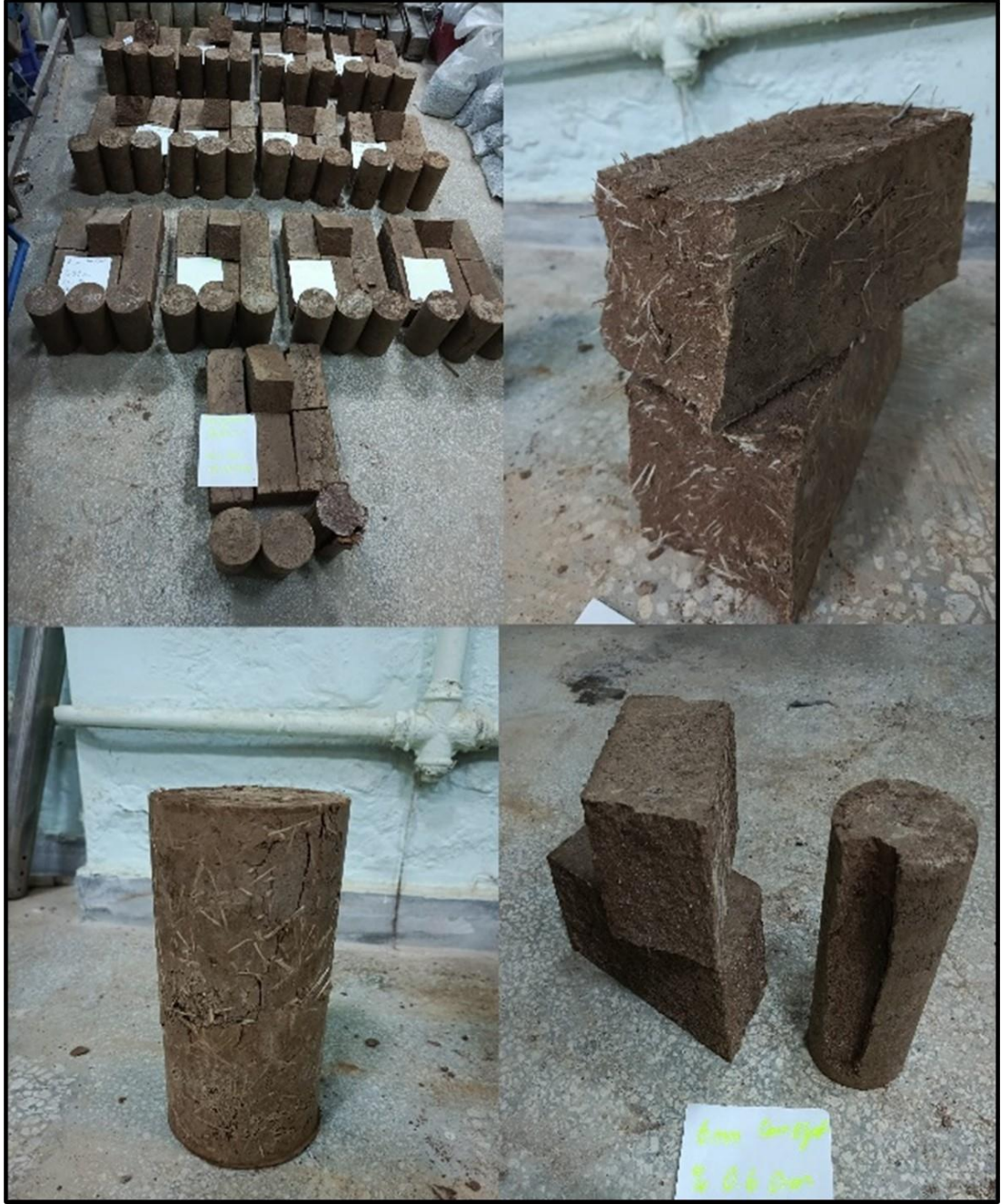
Şekil 3.18. Silindir ve kiriş biçimindeki cam elyaf katkılı numunelerin serbest basınç ve eğilme deneyleri sonrasındaki görünüşleri
