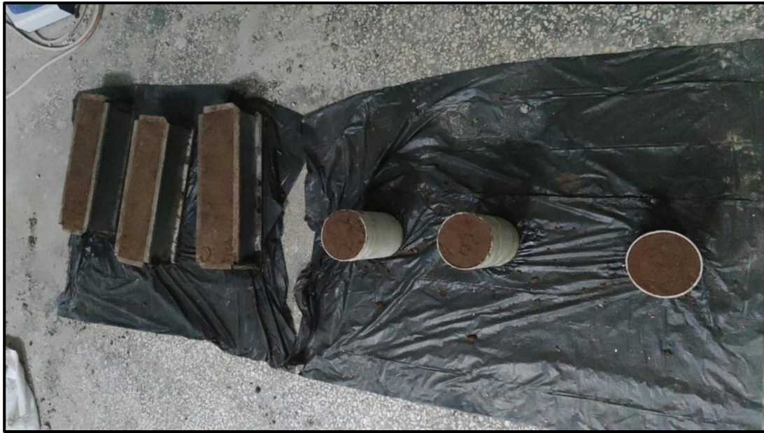
Şekil 3.5. Silindir ve kiriş biçimindeki kalıplara yerleştirilen kontrol numuneleri görünüşleri
