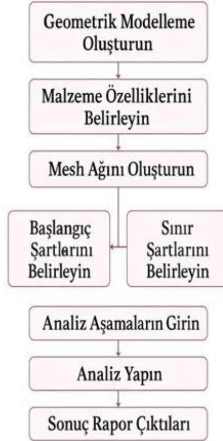
Şekil 3.9. Midas GTS NX Yazılımı İçin İşlem Akış Diyagramı
