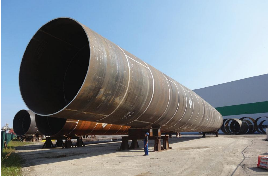
Şekil 1.2. 7.5 m Godewind Offshore Rüzgar Çiftliği İçin Yapılmış Tekil Kazık (Kallehave vd., 2015)
