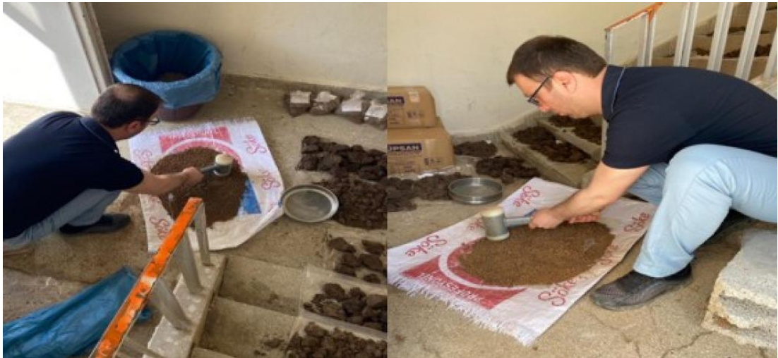
Şekil 3.3. Kurutulan toprakların 2mm 'lik elekten geçirilmesi çalışması
