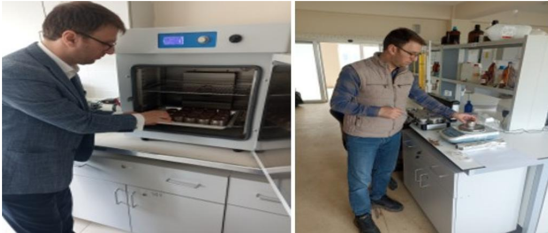
Şekil 4.1. Bozulmamış numunelerin etüvde 105 \text{ }^{\circ}\text{C} 'de 24 saat bekletilmesi ve tartım işlemi
