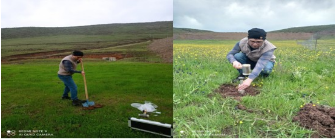
Şekil 3.2. Koordinatları belirlenmiş olan noktalardan bozulmuş ve bozulmamış toprak numunesi alma çalışması
