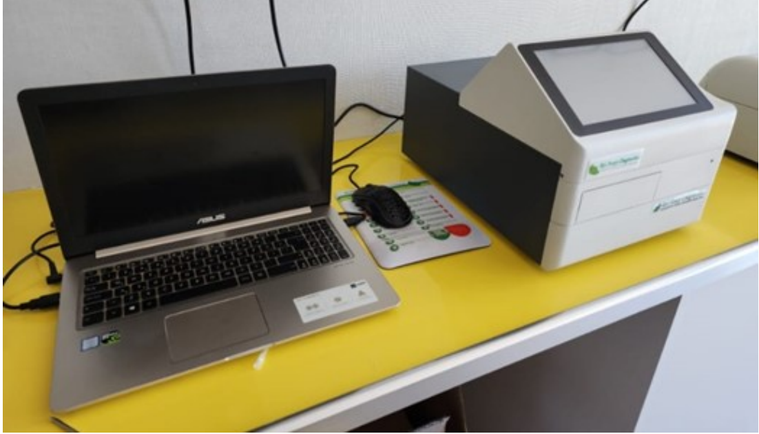
Şekil 3.1. Biyobelirteç Ölçümü İçin Kullanılan ELISA Reader
