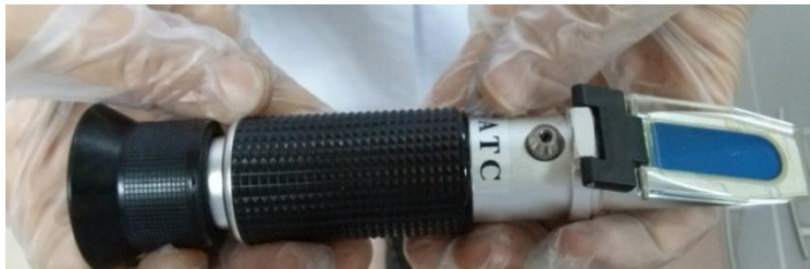
Şekil 3.20. Refraktometre ile brix ölçölümü
