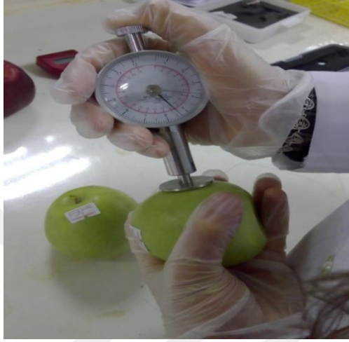
Şekil 3.19. Elma meyvelerinin penetrometre ile sertliđinin ölçölmesi
