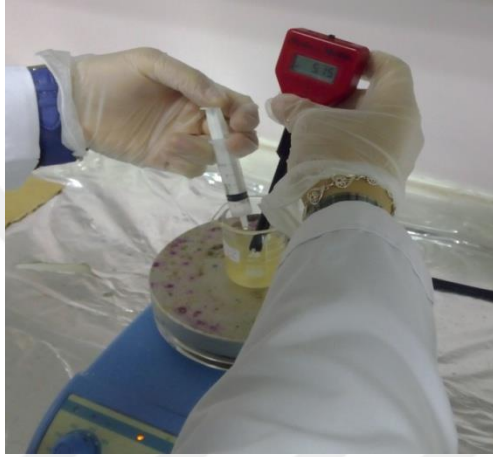
Şekil 3.21. Solüsyonun pH değerinin 8.2 olana kadar NaOH ile titre edilmesi
