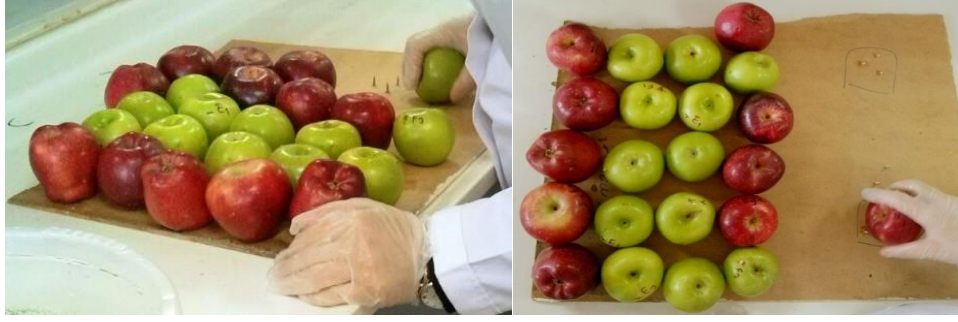
Şekil 3.14. Elma meyvelerinin eşkenar üçgen olacak şekilde (5 mm derinlik \times 1 mm \varnothing ) hasarlandırılması
