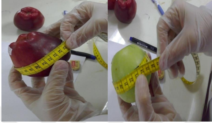
Şekil 3.17. Elma meyvelerinin mezure yardımı ile uzunluklarının ölçülüp çaplarının hesaplanması
