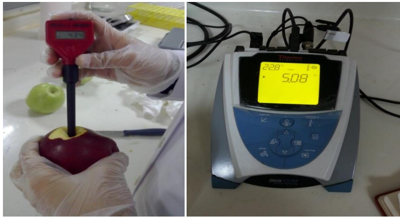
Şekil 3.18. Elma meyvelerinin pH metre ile ölçümü
